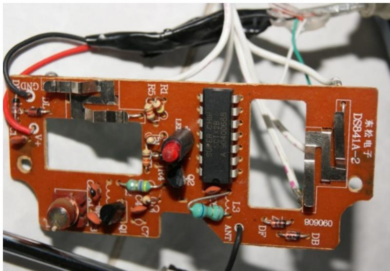
Figura 17, Podemos observar la tarjeta del control remoto del prototipo, en este se soldaron los cables a las Entradas (Derecha, Izquierda, Adelante, Atrás) de frente.
