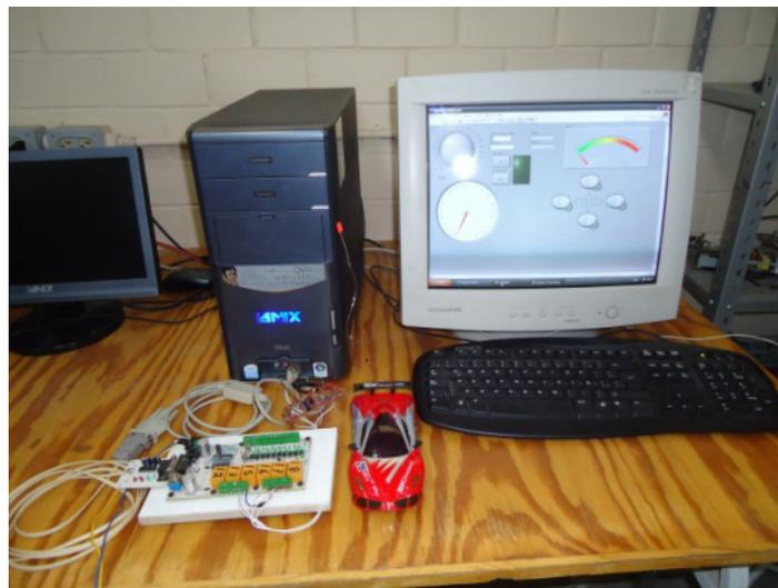
Figura 15, Podemos observar que en el conector USB, que está conectado el convertidor USB a Serial (RS232), de este se conecta al convertidor de Serial al TTL (5V.).
