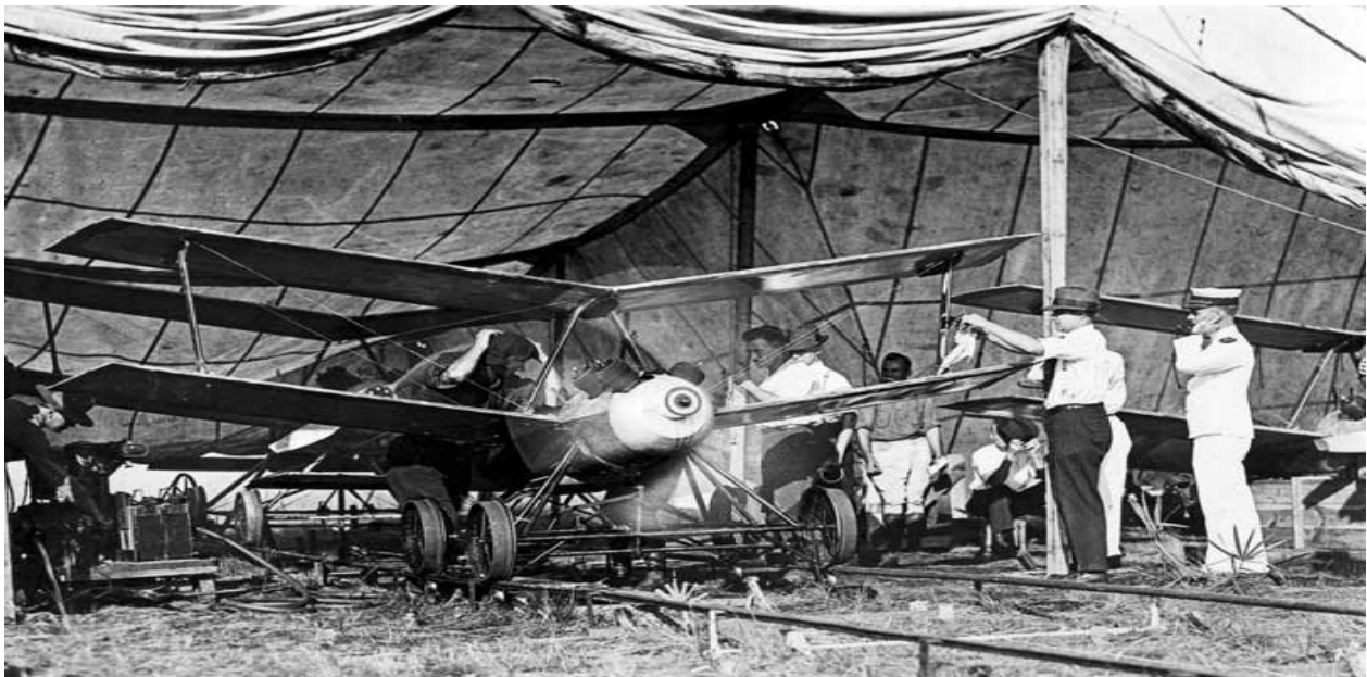
Figura 1. El bicho de Kettering. Primer dron utilizado en la historia
